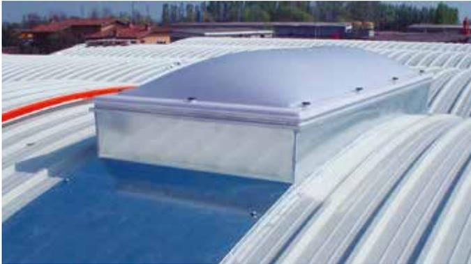
Basamento da comporre in opera per accoppiamento a pannello curvo coibentato, realizzato in lamiera di acciaio zincata o preverniciata bianco/grigio standard, sagomato per essere, su due lati, sovrapposto alla copertura e su due lati appoggiato sulle travi.
